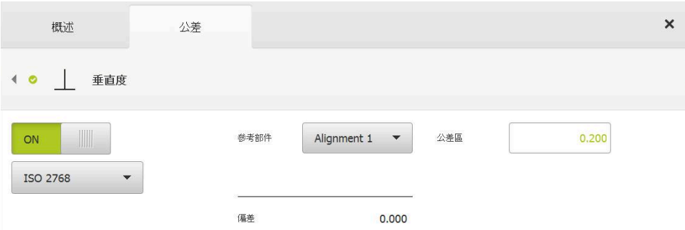
圖形 75: 方向公差 概述，已啟動 垂直度公差，依照 ISO 2768
