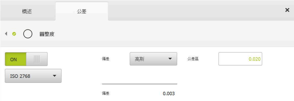
圖形 73: 形狀公差 概述，已啟動 圓整度公差，依照 ISO 2768
