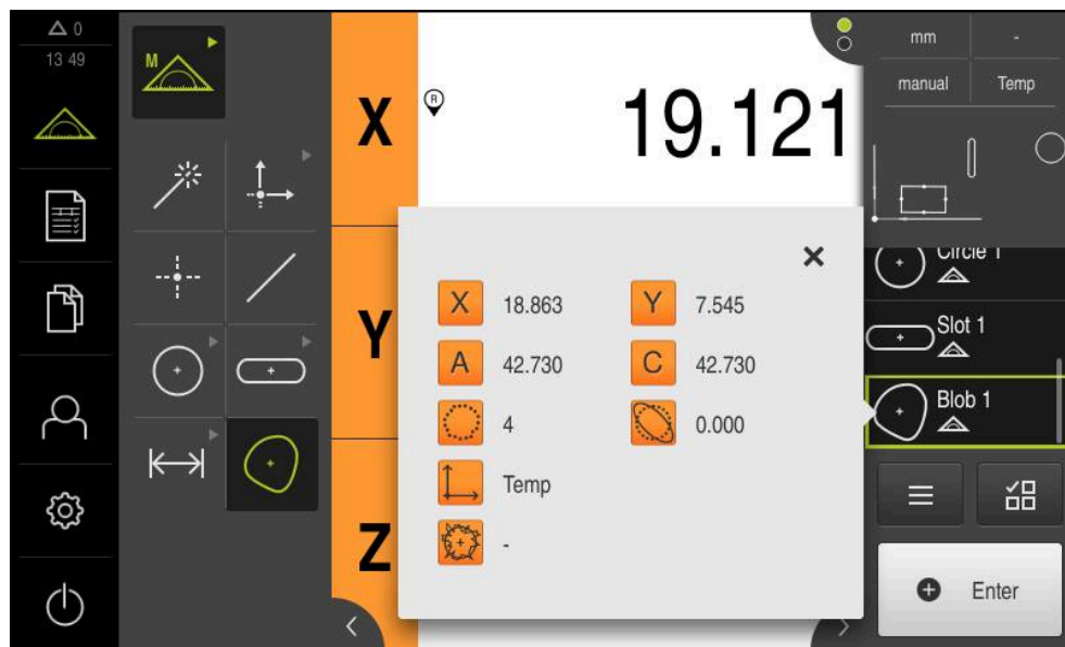
圖形 40: 部件清單內的任意形狀部件，含量測結果預覽
