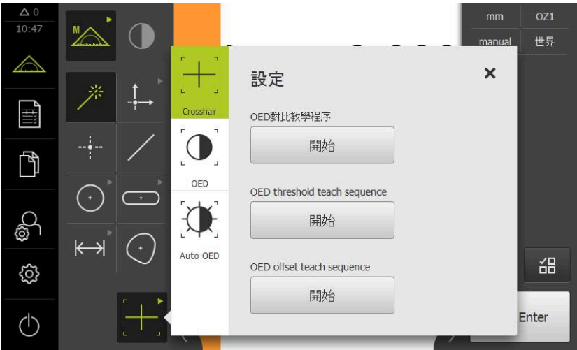
圖形 18: OED量測刀具的 設定 對話
