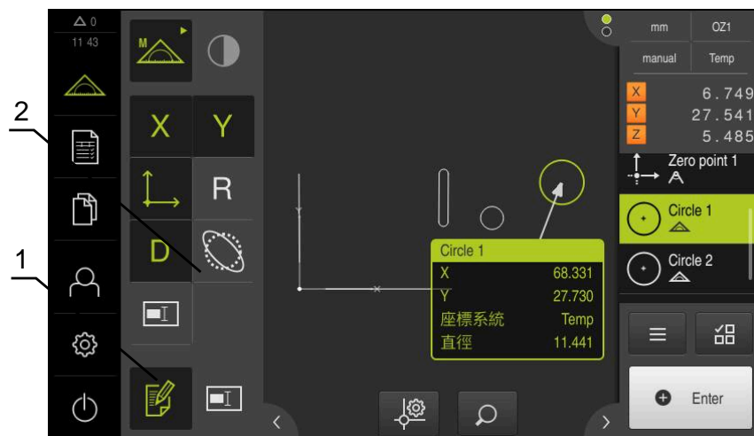
圖形 21: 在部件預覽中具有注釋的部件
