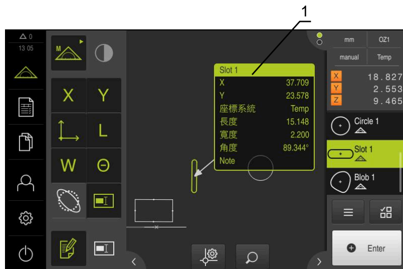
圖形 77: 含部件的量測資訊之部件畫面
